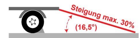
Die Auffahrschienen dürfen nur mit einer maximalen Geschwindigkeit von 0,3 m pro Sekunde befahren werden.
