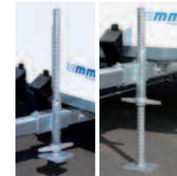
mutter, einem Flugzeugpropeller ähnlich, die entlang dem in die Schwerlaststütze eingefrästen Gewinde bis zum Anschlag nach oben gedreht ist, so daß die Stütze voll-
